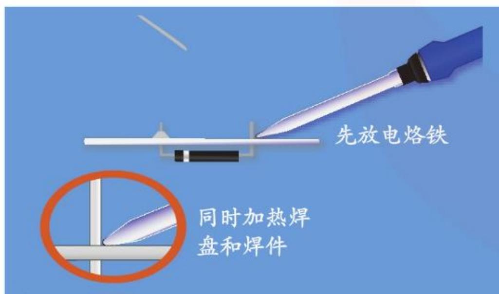
1. 左手拿锡线，右手拿电烙铁，烙铁头靠在焊盘焊件的连接处进行加热。
